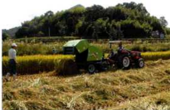
ロールペーラによる飼料イネ収穫状況
